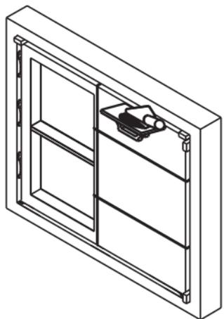
Preencha o vão com a massa e após a secagem, retire os calços e complete o espaço com a massa.
