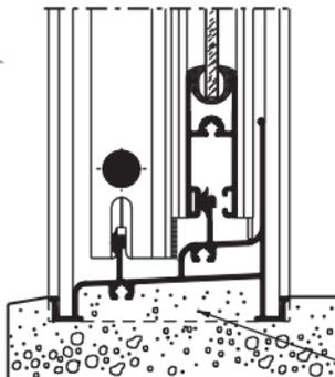
Coloque massa (3:1) na base do vão, após isto, encaixe a peça no vão sobre a massa e posicione calços nas **LATERAIS** da peça.
