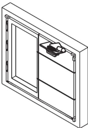
Preencha o vão com a massa e após a secagem, retire os calços e complete o espaço com a massa.
