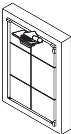
Preencha o vão com a massa (3:1) e após a secagem, retire os calços e complete o espaço com a massa.
