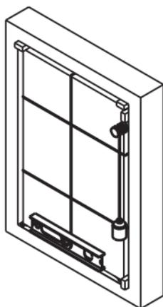
Encaixe a peça no vão e posicione calços nas **LATERAIS** da peças.
