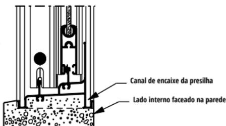
Certifique-se que sua janela ou porta esteja instalada rente ao acabamento interno da parede. Depois, remova todos os resíduos de massa e tinta dos canais. Em seguida, passe um pano umedecido no marco da janela.
